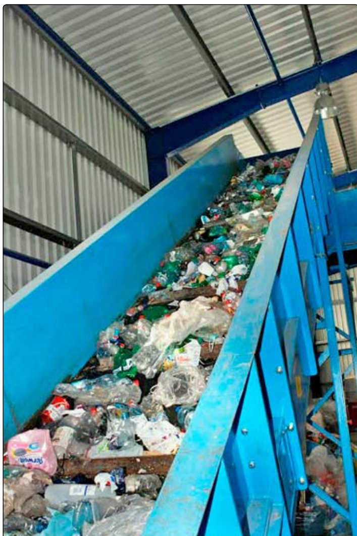
Dopravníkový pás na separačnom zariadení, ktorý prenáša plasty na triediacu linku (SITA Slovensko, prevádzka Levice)
