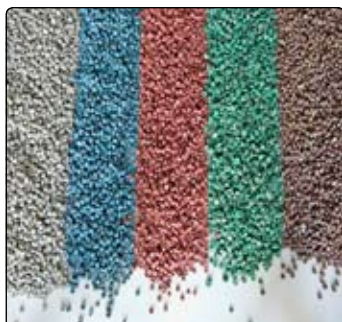
Z PET sa v recyklačných závodoch stáva regranulát, ktorý slúži ako polotovar na výrobu nových PET
